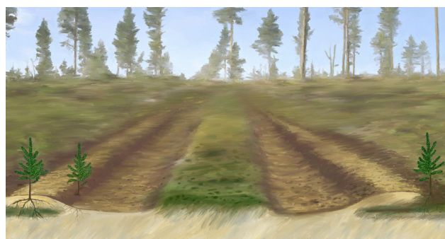
Bracke T26.b erzeugt Pflanzstellen mit umgedrehter Erdscholle (T), Mineralbodenhaufen auf umgedrehter Erdscholle (H) sowie Mineralbodenhaufen auf Mineralböden (M).
