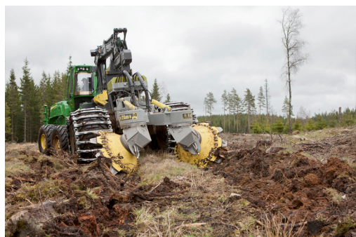
Bracke T26.b wird auf einer mittelgroßen oder großen Basismaschine montiert.
