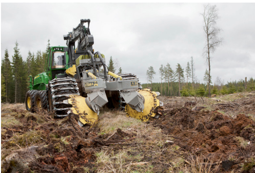
Bracke T26.b asennetaan keskisuuriin tai suuriin peruskoneisiin.
