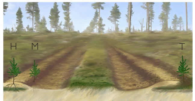
Bracke T26.b muodostaa istutuspaikat kaksinkerroin käännettystä kunnasta (T), kaksinkerroin käännettystä kunnasta ja kivennäismaasta (H) tai kivennäismaasta (M).
