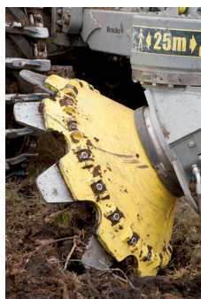
Disques à dents remplaçables.
