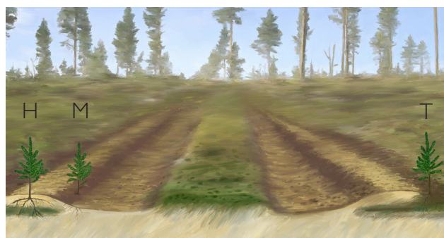
Bracke T26.b skapar planteringsställen med omvänd torva (T), mineraljordshög på omvänd torva (H) samt mineraljordshög på mineraljord (M).
