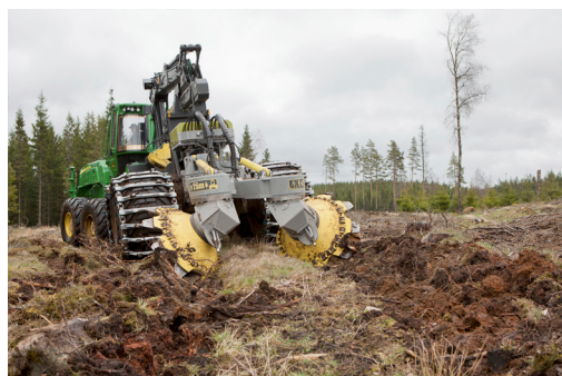
Bracke T26.b monteras på en medelstor eller stor basmaskin.
