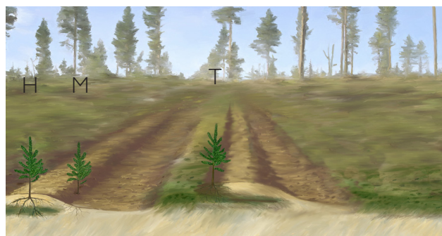
Le Bracke T28.b forme des microsites de plantation d'humus retourné (T), de sol minéral sur humus retourné (H) et de sol minéral sur sol minéral (M).
