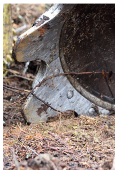
Les dents des disques sont remplaçables.
