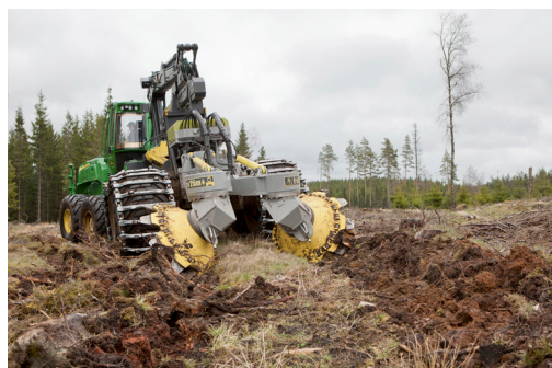
Le Bracke T28.b peut se monter sur un engin porteur de taille moyenne ou de grande taille.
