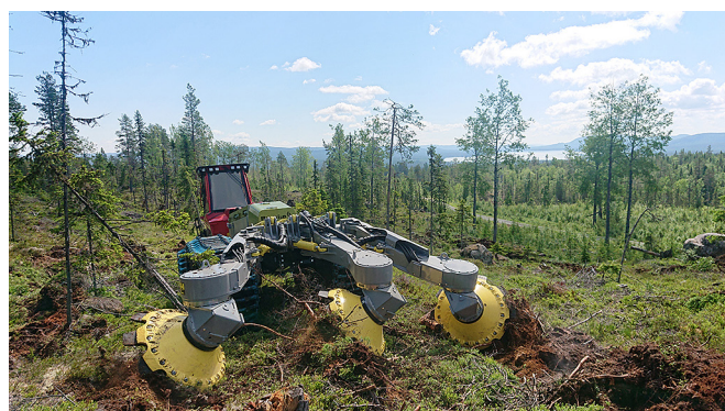
Le Bracke T35.b convient aux scarificateurs de grande taille et peut être monté sur des engins porteurs de grande taille.
