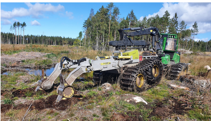
In Kombination mit einem mittelgroßen Forwarder liefert der Bracke M24.a auf jedem Untergrund hervorragende Bodenvorbereitungsergebnisse.
