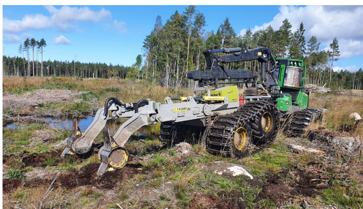
Bracke M24.a på en medelstor skotare ger ett mycket bra markberedningsresultat på alla högläggningsmarker.
