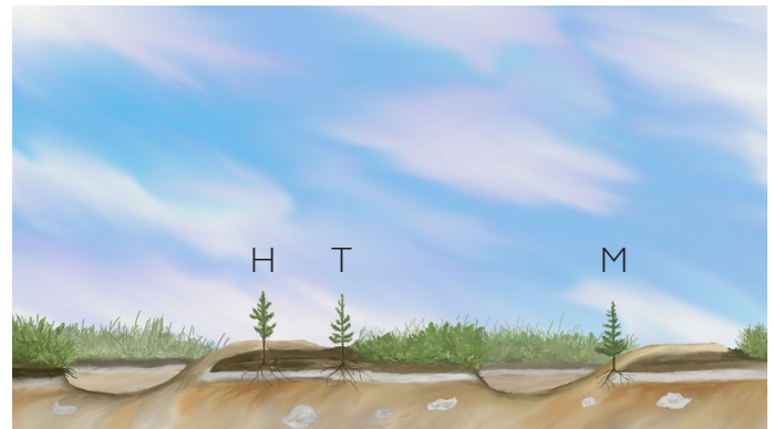
Bracke M46.b skapar planteringsställen med omvänd torva (T), mineraljordshög på omvänd torva (H) samt mineraljordshög på mineraljord (M).
