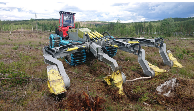
Markberedning med M46.b ger plantor och frön bästa möjliga förutsättningar att växa och överleva oavsett terräng.
