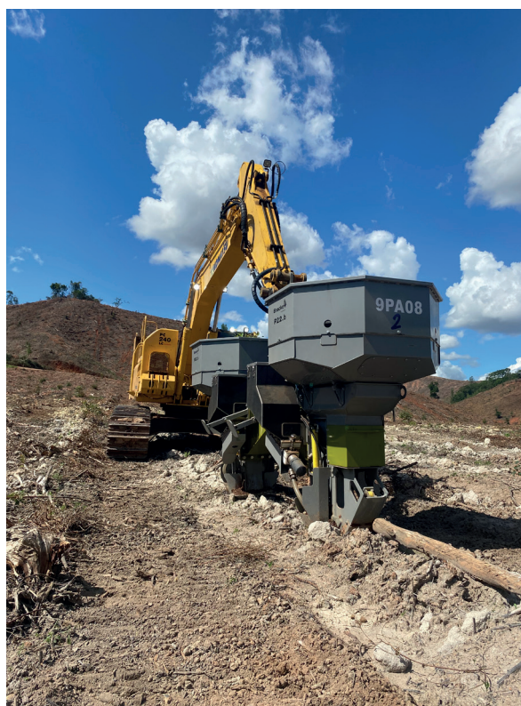
A Bracke P22.b é montada com um rotator e uma conexão que permite que as mudas sejam plantadas na posição vertical.
