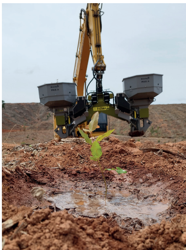
A Bracke P22.b realiza a bacia para concentrar a água de irrigação próxima à muda
